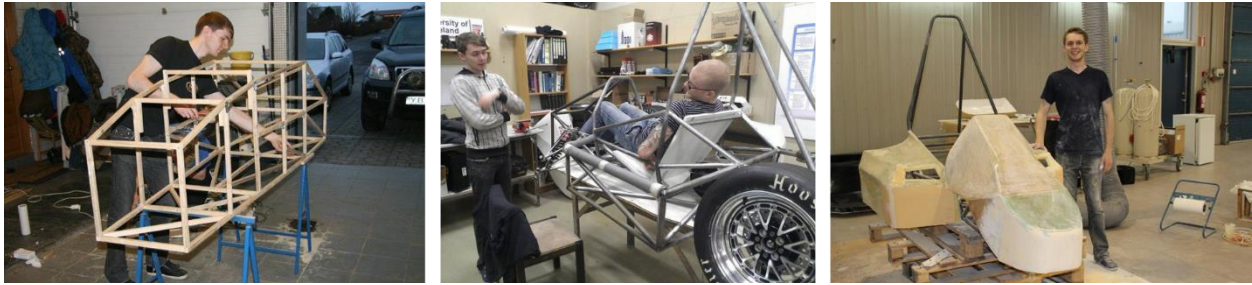
Mynd 10: Grindin í kappakstursbílnum þróaðist mikið frá fyrsta trémódelinu. Lengst til hægri er fyrsta skelin sem við smíðuðum í OK Hull.
