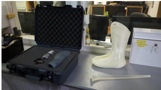
Mynd 14: Þrívíddarprentun fyrir Össur hf. Ég þrívíddarprentaði stand til að þurrka sílíkonhulsur, þrjár spelkur fyrir Valgeir Pétursson og nýju EVA Walker spelkuna fyrir Lárus Gunnsteinsson. Allir voru mjög ánægðir með útkomuna.
