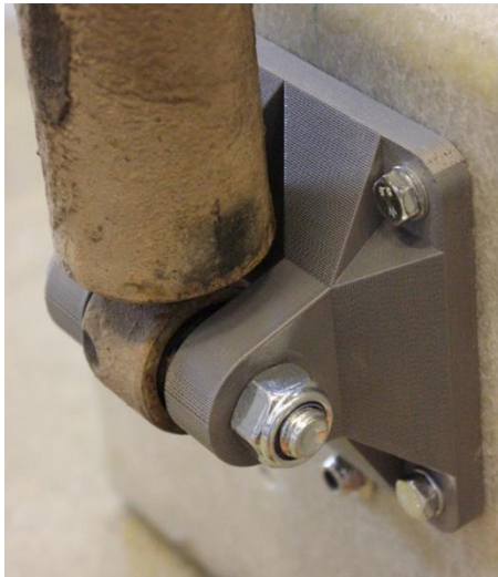
Mynd 18: Praktískar prótótýpur: Demparafesting vinstra megin og deileistútur fyrir ískrapavel í kjúklíngavinnslulínu hægra megin.
