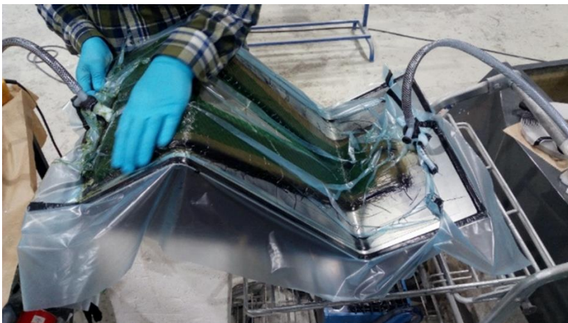
Mynd 33: Við notuðum vacuum infusion aðferðina til að smíða fjaðrirnar í sætinu. Það er góð leið til að stýra resinhlutfallinu og fá léttu og sterka parta.
