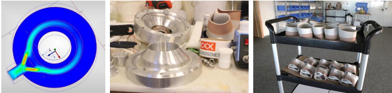
Mynd 10: Vinstri: CFD módel af einni fyrstu tilrauninni til að hanna sílíkondísu. Miðja: Sílíkondísan sem var búin til var töluvert öðruvísi. Hægri: BRIM framleiðslan hjá OK Prosthetics.
