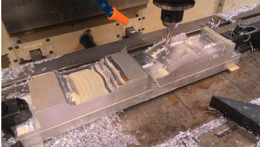
Mynd 44: Fræsing á fyrra mótinu og borun til að koma fyrir hitara og hitanema.
