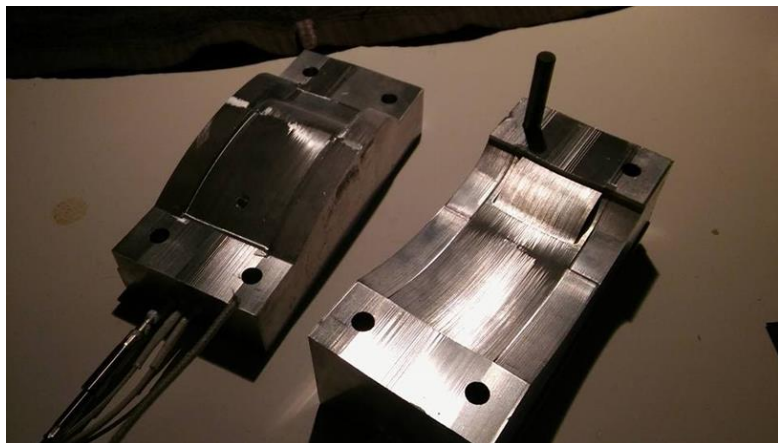
Mynd 45: Fyrri og seinni útgáfa sylgjumótsins. Sylgjurnar festust í fyrra mótinu, svo að hönnuninni var breytt talsvert.
