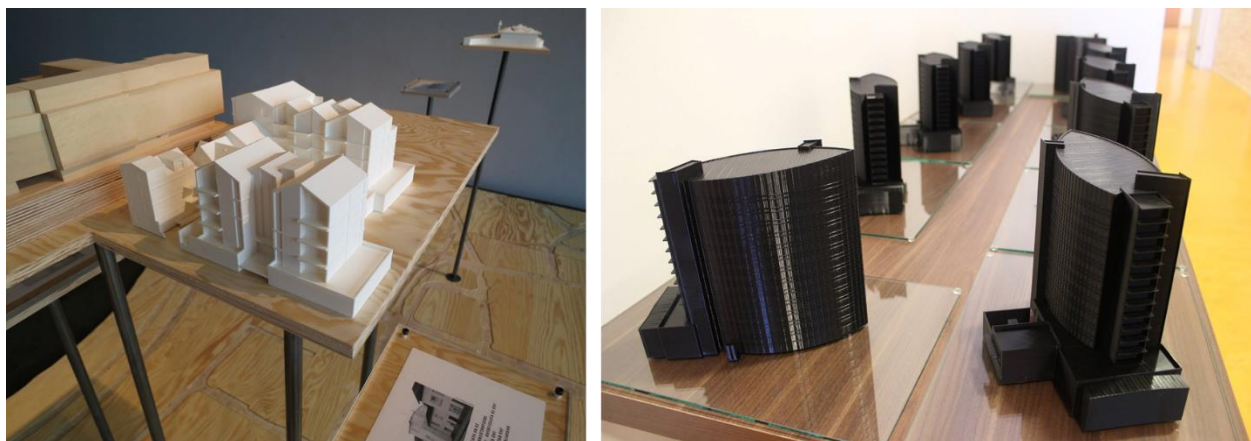
Mynd 16: Sketchup mólum frá arkitektum eru almennt ekki prentanleg. Teikna þurfti þessi mólum upp á nýtt.
