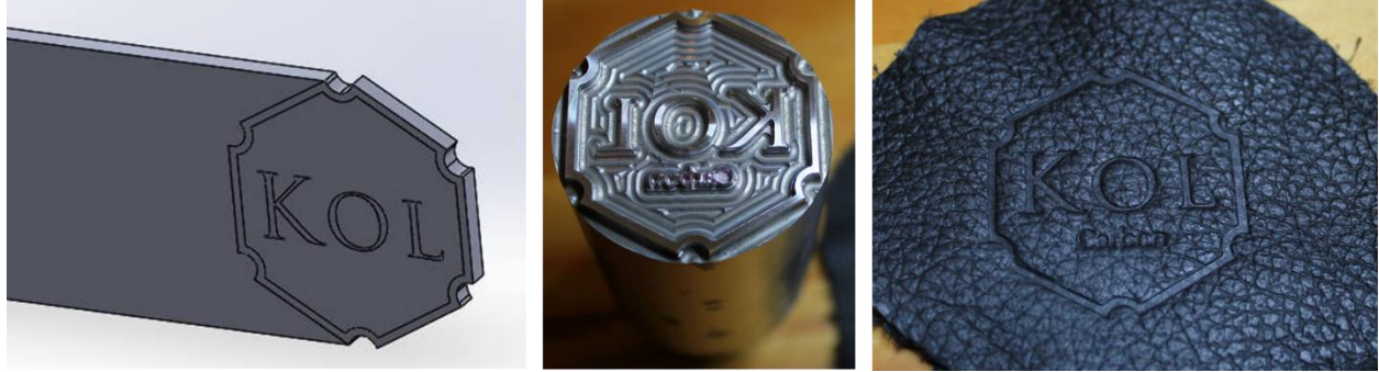
Mynd 46: KOL lógóið var stansað í enda beltisins. Þá þarf að muna að spegla lógóinu þegar stansinn er fræstur út.
