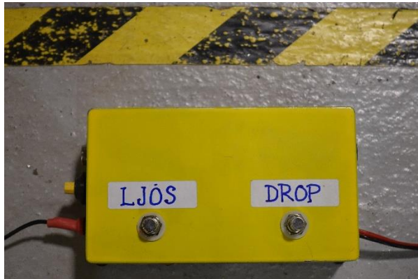
Mynd 41: Stýriboxið fyrir fallturninn samhæfir sleppingu sætisins og háhraðamyndbandsupptökuna. Örtölvan í boxinu er tengd við tölvu sem keyrir Matlab.
