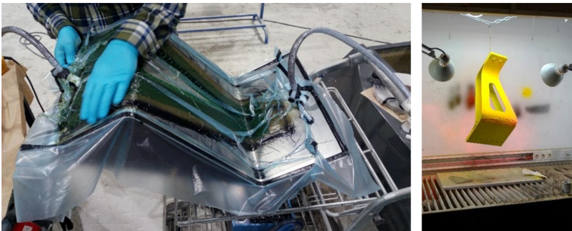
Mynd 20: Við notuðum vacuum infusion aðferðina til að smíða fjaðrirnar í sætinu. Það er góð leið til að stýra resinhlutfallinu og fá léttu og sterka parta.
