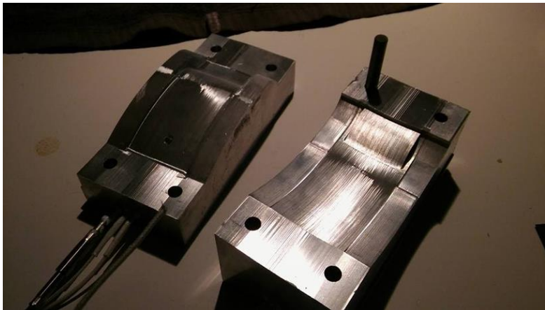
Mynd 32: Fyrri og seinni útgáfa sylgjumótsins. Sylgjurnar festust í fyrra mótinu, svo að hönnuninni var breytt talsvert.
