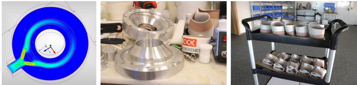
Mynd 6: Vinstri: CFD módel af einni fyrstu tilrauninni til að hanna sílíkondísu. Miðja: Sílíkondísan sem var búin til var töluvert öðruvísi. Hægri: BRIM framleiðslan hjá OK Prosthetics.
